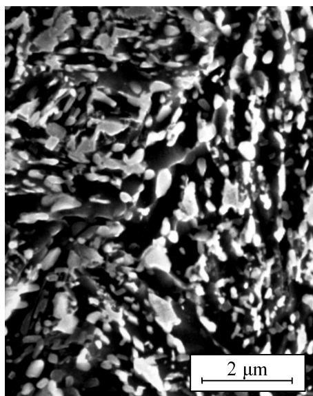
Obr. 9. Detail pásma na rozhraní, tvoreného veľmi jemnými karbidmi.
