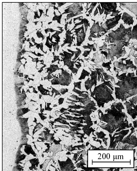
Obr. 4. Tepelne ovplyvnená oblasť v strede návaru.
