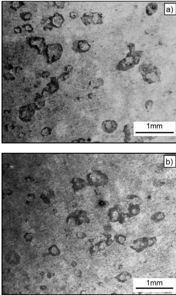
Fig. 5. SEM morphology of a) 10 vol.% B<sub>4</sub>C and b) 30 vol.% B<sub>4</sub>C composites.
